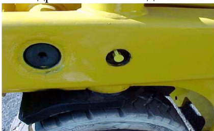
Рисунок 29. Шкворни управляемых колес.
