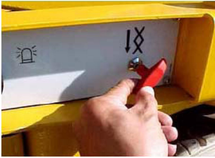
Рисунок 21. Тяга аварийного опускания рабочей платформы.
