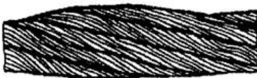
Рисунок 13. Местное увеличение диаметра каната.
