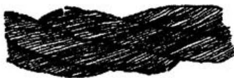
Рисунок 1. Обрывы и смещения проволок каната крестовой свивки.
