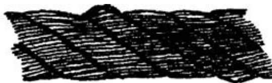
Рисунок 1. Обрывы и смещения проволок каната крестовой свивки.
