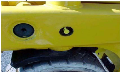
Рисунок 29. Шкворни управляемых колес.
