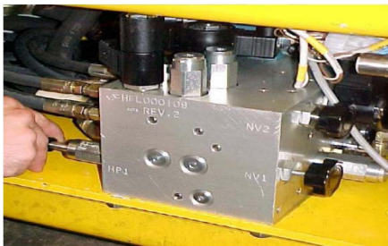
Рисунок 24. Аварийное растормаживание колес подъемника.
