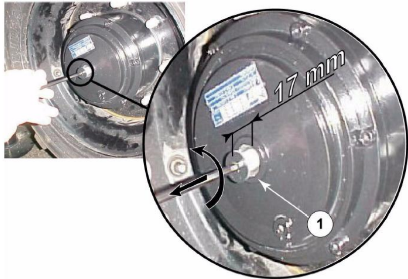
Рисунок 22. Отключение колес от колесных редукторов.
