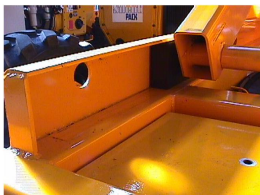
Рисунок 30. Направляющая скольжения пантографной стрелы
