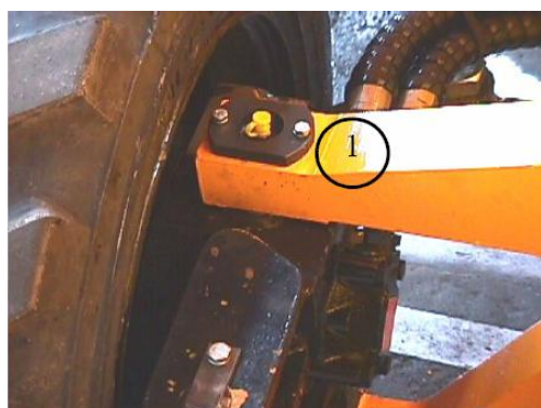
Рисунок 29. Шкворень поворотного колеса
