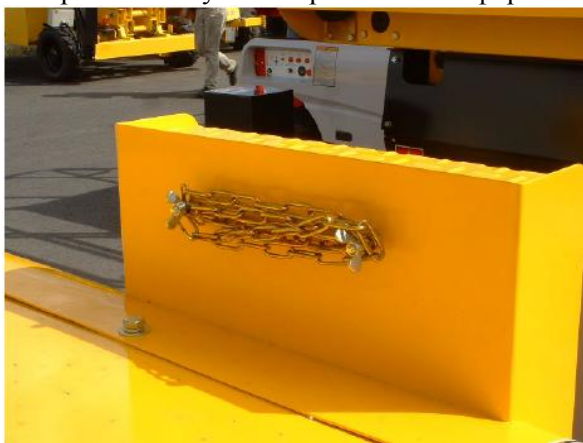
Рисунок 21. Расположение цепочки для аварийного опускания рабочей платформы.
